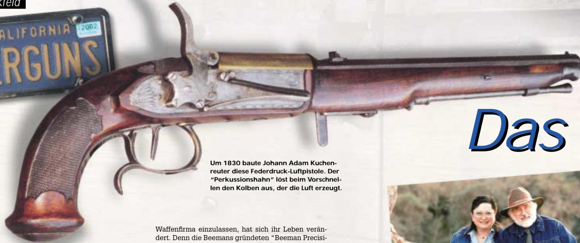
Um 1830 baute Johann Adam Kuchenreuter diese Federdruck-Luftpistole. Der "Perkussionshahn" löst beim Vorschnellen den Kolben aus, der die Luft erzeugt.
